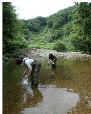
河川底質のサンプリング：底質中の重金属を存在形態別に分析して生物影響を評価します。
