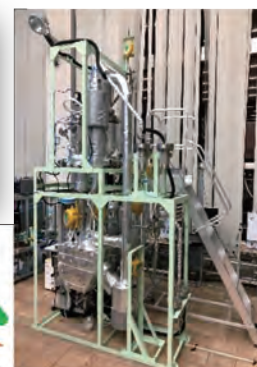
小型バイオマスガス化炉
