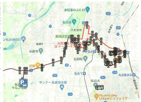
運用を開始したバスロケーションシステムの画面。赤色が土手町循環バスで、紫色が相馬・西目屋線。バスのアイコンが位置情報に沿って10秒ごとに移動する
