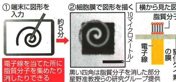
星野准教授によると、窒化ケイ素の膜の上に細胞膜のシートを作り、裏側から電子線を当てて、コンピューターで、病気の抗体や大並みの嗅覚センサーなどの開発に大きく寄与する見通し。論文は10月29日に学術誌「コロイド&サーフィス」オンライン版に掲載された。(赤田和俊)
