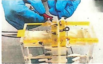
佐々木教授の実験の様子。リチウムを含む水溶液に電気を流すと、リチウムイオンだけが左右を仕切る電解質膜を通して容器左側から右側へ移る(弘前大学提供)
