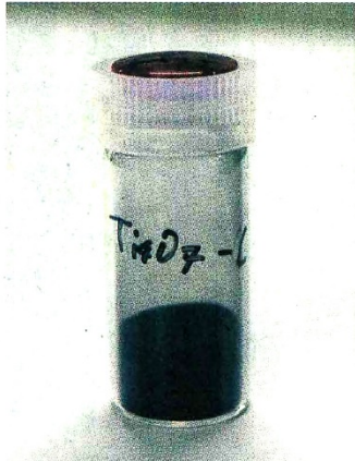
新たな触媒として研究グループが開発したチタン酸化物。安価に大量合成でき、世界最高レベルの耐劣化性能が得られた
