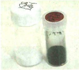
大量合成技術の確立に成功したチタン酸化物⑤。同じ元素で構成する酸化チタン⑥は白く、電導性がない
