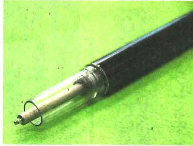
【写真上】共同研究で開発した「超精密高速温度センサ」(左側の先端部分)。皮膚に当てて温度を計測する【同下】「超精密高速温度センサ」のイメージ図(八戸高専提供)
