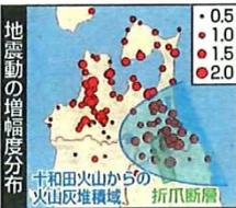
三八地域はやはり「揺れやすい」。発生した地震の規模に比べて、震度が大きく出やすいとされる八戸市南郷や階上、五戸などの観測地点。弘前大大学院理工学研究所の片岡俊一教授(右)らの調査によって、硬質な地盤の上に軟質な火山灰層が堆積している同地域特有の地盤構造が、地震動をより大きくしていることが分かった。三陸沖などを震源とする海溝型地震に加え、青森県南地方から岩手県北地方を貫く活断層「折爪断層」を震源とする地震の発生も想定される同地域。片岡教授は「各自治体が独自の被害想定を実施し、対策を講じることが必要」と提言する。(松橋広幸)
