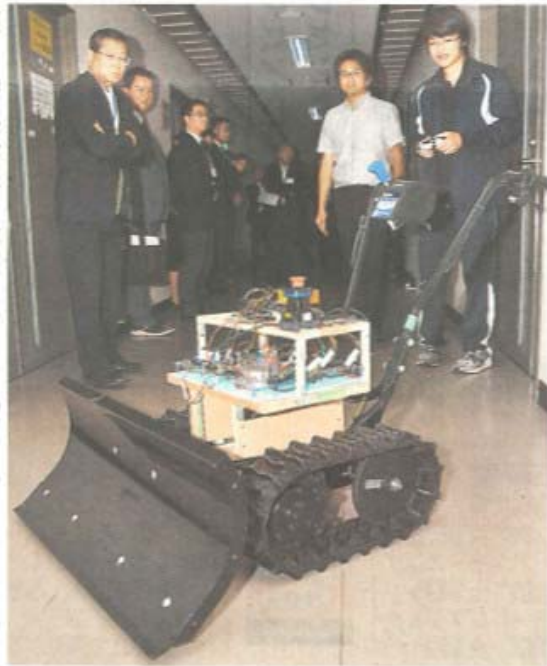
フォーラムで公開された自律除雪ロボット。右から2人目が開発を進めている竹田助教
