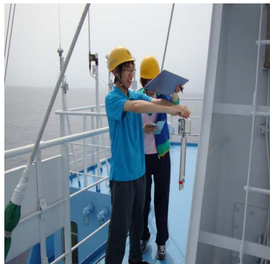
アスマン乾湿計を用いて観測中
