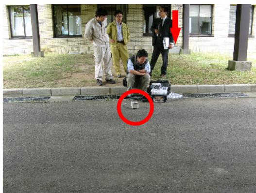
写真-5 胆沢における微動計測風景. 奥の赤い矢印の先にあるコンクリート升が震度計のケース. 赤丸で囲まれているものが微動計. 写真右側が概ね北.
