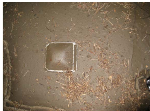
写真11 荒浜観測ステーション内部 (津波漂流の泥で覆い尽くされた地震計センサー)
