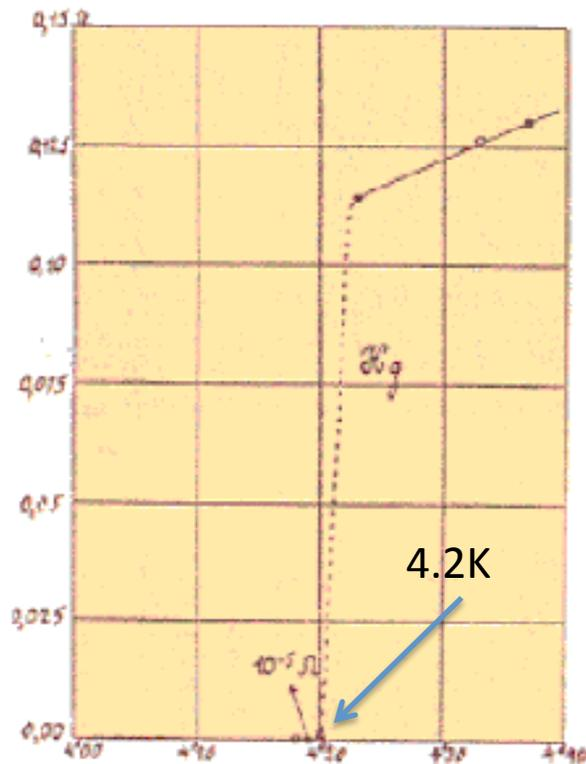
オンネスによる水銀の電気抵抗の温度依存性のデータ。
