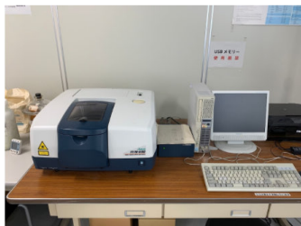
赤外分光光度計 (IR) FT/IR-6100 (JASCO)
