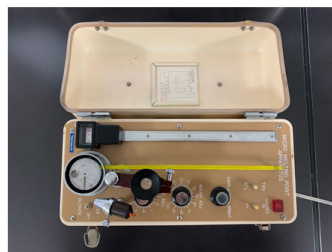
微量融点測定装置 MP-S3 (Yanaco)
