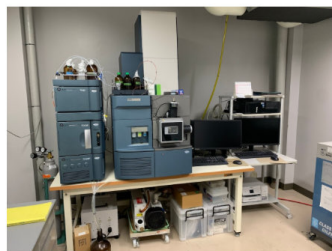
質量分析装置 (LC-MS, ESI) Xevo G2-XS QTof (Waters)
