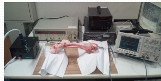
図. ウシ大腿骨を用いたガイド波計測実験の様子
