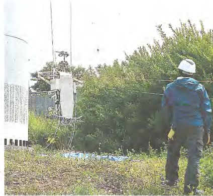
【写真上】風車ブレードに向かって上昇するメンテナンスロボット 【同左】ブレードを点検するロボット
